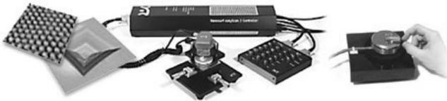
Die Technologie nennt sich «RasterTunnelmikroskopie»: Eine Tastnadel gleitet zeilenweise über ein zu observierendes Material. Dabei gleitet der Nadelkopf mit einem win-
