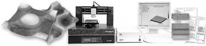
Mit dem neu entwickelten Raster-Kraftmikroskop können Oberflächen in direktem, mechanischem Kontakt abgetastet werden. Es besitzt weiter den Vorteil, dass es auch nichtleitfähige Gegenstände vergrössert darstellen kann. Das Rasterkraftmikroskop, setzt sich heute in modifizierter Form unaufhaltsam in Industrie, Forschung und Wissenschaft durch.
